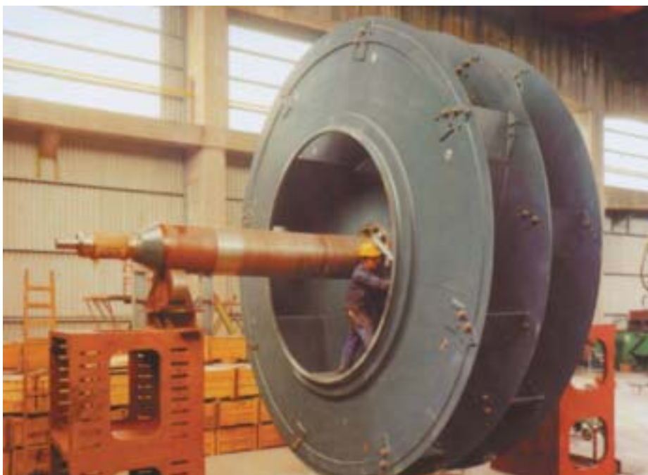
Rotor for a mine fan
